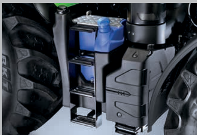
Mindre forbrug af diesel og AdBlue®. Tankkapaciteten til diesel og AdBlue® er 400 liter og 50 liter, hvilket rækker til de lange arbejdsdage.
