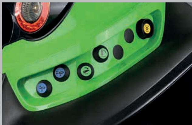
Udvendig betjening af lift, PTO og en hydraulikventil er integreret i bagskærmene på begge sider af traktoren.
