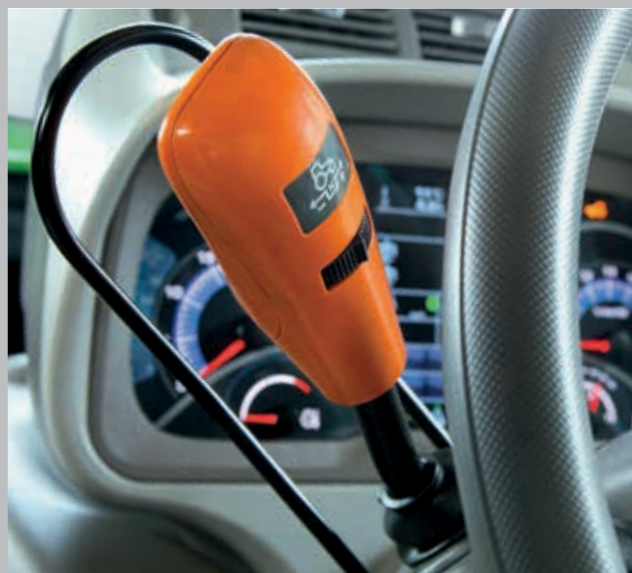
PowerShuttle med SenseClutch - 5 indstillinger af følsomhed/reaktionshastighed.
