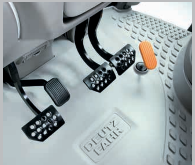
Boost-bremser sikrer høj bremseeffekt trods lavt pedaltryk. (Her vist med ekstra pedal til motorbremse)
