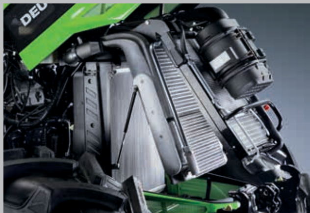
Nyt servicevenligt design af kølersystemet. Placeringen i fronten gør det nemt at gennemføre service, selvom traktoren er monteret med frontlæsser.
