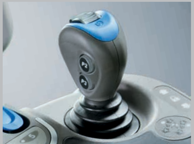
Hydraulikventilerne betjenes via et smart kørehåndtag med trykknapper til ISOBUS-funktionen.
