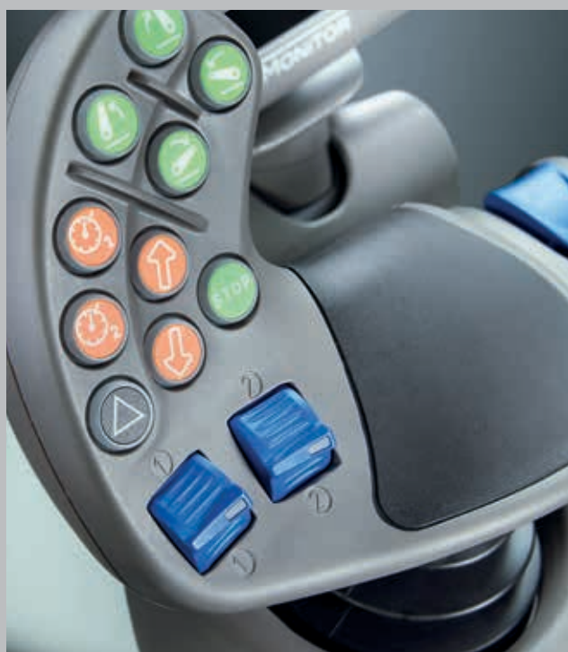
Op til 4 cruise-hastigheder kan lagres i traktorens styring og nemt betjenes via trykknapper på joysticket.
